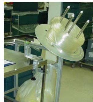
**ROČNI REZALNIK CEVK brez/z odvijalnim kolutom**
