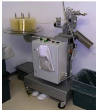
Namenski rezalnik kratkih cevk iz koluta.
